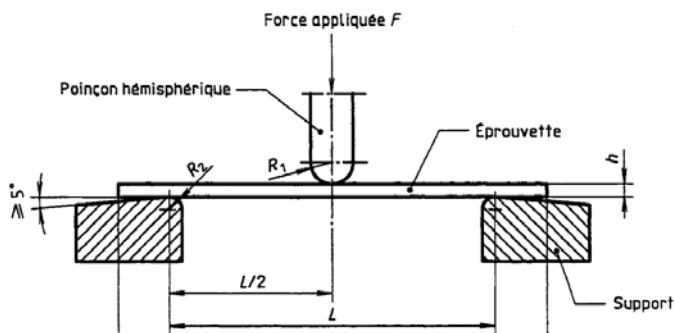
L : la distance entre les appuis en millimètre : 220 mm
